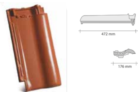
taška poloviční - hmotnost 1 ks cca: 2,5 kg - střední krycí šířka cca: 12,5 cm Poloviční taška není vhodná do úžlabí! Taška v zámku nenavazuje na základní tašku! Zámek má jiný tvar. Používá se jen jako jedna řada tašek od okapu do hřebene, pro dosažení rozšíření krycí šíře střešní krytiny o krycí šířku poloviční tašky, což je cca 125 mm.
