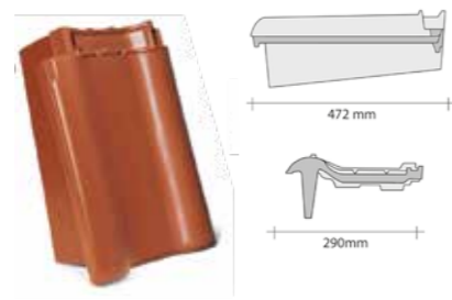
taška okrajová levá - krycí délka cca: 36,5–40,3 cm - krycí šířka cca: 33,5 cm - hmotnost 1 ks cca: 5,7 kg Spotřeba cca 2,7–2,4 ks/bm délky okrajové hrany.
