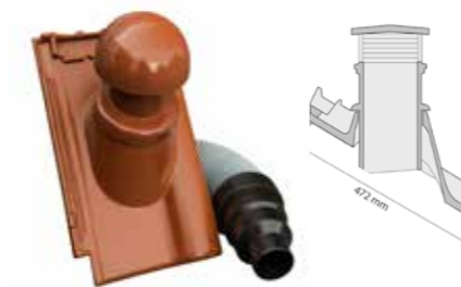
komplet pro odvětrání kanalizace: prostupová taška, nástavec, flexi hadice - díky rotační trubce se dokonale přizpůsobí sklonu střechy - optimální sklon střechy - hmotnost tašky: 4,1 kg - hmotnost hadice cca: 3,0 kg - celková hmotnost 1 ks cca: 7,1 kg - vnitřní průměr otvoru Ø cca: 100 mm
